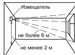
Рисунок 5 – Установка извещателя на противоположной стене
