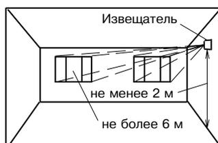
Рисунок 4 – Установка извещателя на боковой стене
